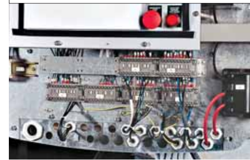
电气连接端子板示例
