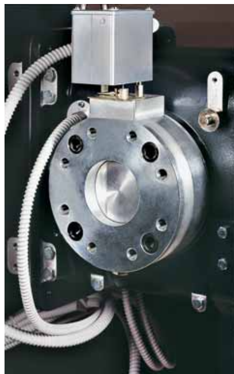
MB 4 SE型燃烧器燃气调节蝶阀示例
